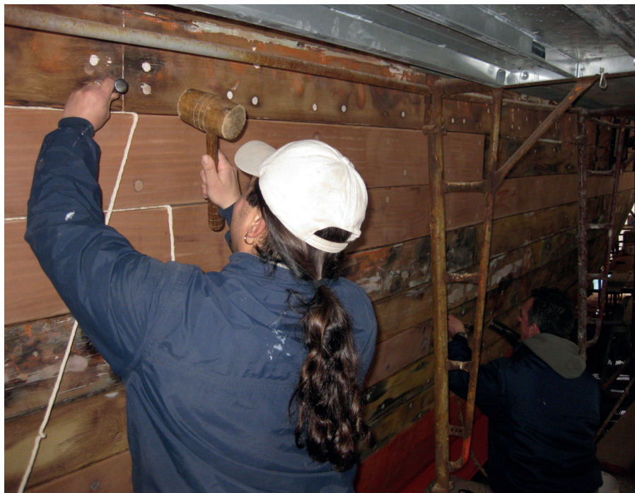
Operazione di calafataggio (fonte: Daily Nautica)
